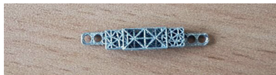
Рис. 2. Титановый имплантат центральная часть балочная 600–800 и 600–1000 мкм
