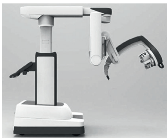
Рис. 8. Прототип робот-ассистированной системы da Vinci SP Fig. 8. The prototype of the robot-assisted Da Vinci SP system
