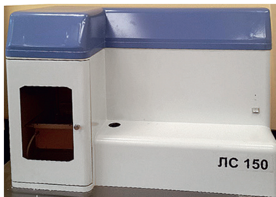
Рис. 2. Лазерный стереолитограф ЛС-150
